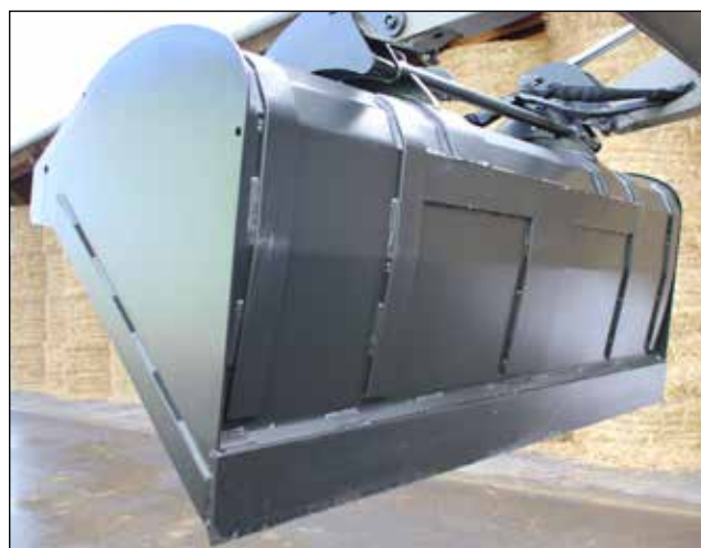
Liczne płyty ślizgowe zapewniają całkowitą ochronę spodu łyżki.
