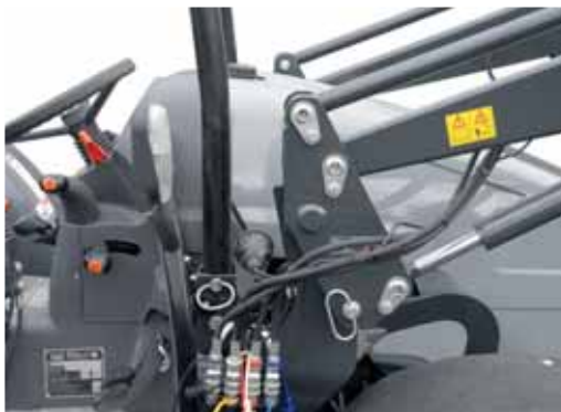
Ładowacz i traktor są bezpiecznie połączeni specjalnym systemem zachodzącym. Zdjęcie pokazuje zamontowany ładowacz czołowy z dołączonymi złączami hydraulicznymi.
