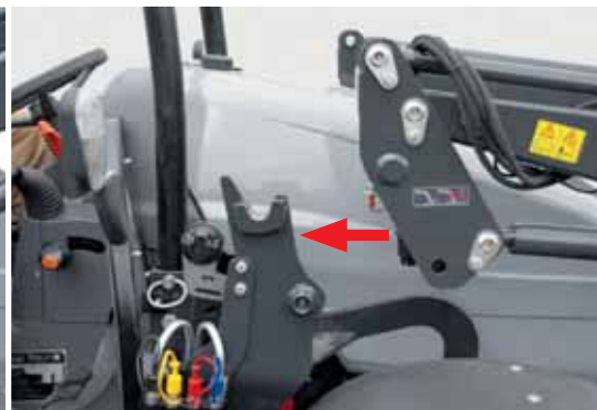
Ładowacz czołowy jest odłączony od ustawienia tylko kilkoma ruchami ręki. Poprzez układ sterowania kolumna mocująca zostaje „wykrecona” z mocowania, wsporniki opuszczone, a hydraulika odcepiona.
