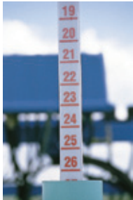
Miernik poziomu cieczy na pływaku, z bezpośrednim odczytem w wyposażeniu seryjnym
