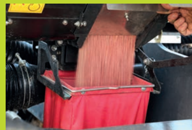
Zasuwka spustowa Umożliwiająca całkowite opróżnienie zbiornika
