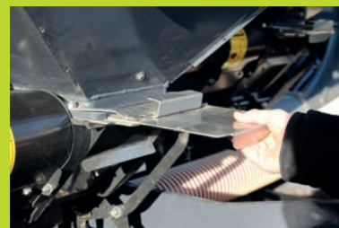
Zasuwka ze stali nierdzewnej W celu odizolowania dozownika
