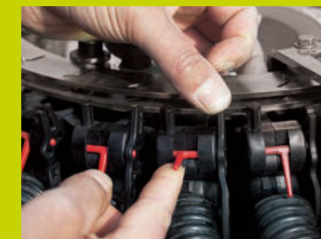
Głowica rozdzielająca ADS Z dowolną obsługą liczby rzędów wysiewających
