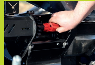
Przestawne koło zębate Dla wysiewu drobnonasiennych
