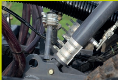
Centralna regulacja hydrauliczna głębokości wysiewu
