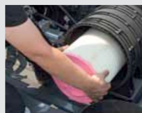
Czyszczenie filtra powietrza
